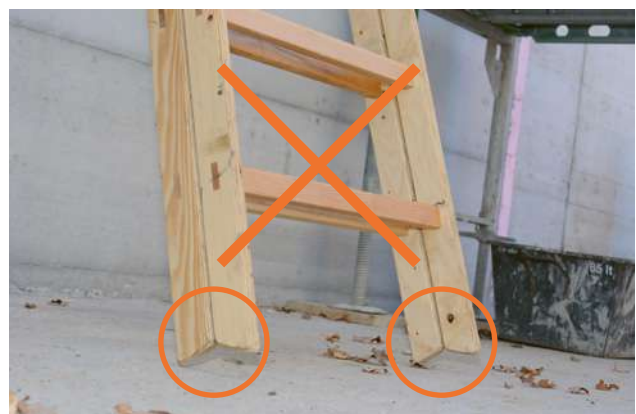
26 Se la scala doppia a un tronco di salita viene utilizzata in appoggio, questa poggia sul pavimento solamente con lo spigolo dei piedi
